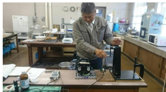
すべり試験の様子 ※東北測器株式会社製 すべり試験機(ONO・PPSM)
